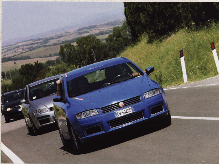
ルート途中で待ち伏せしていたら来た来た! 先頭は2.4直5DOHC20バルブで170psのアバルト仕様。なお、ステイロは現在もブラジル工場で生産が継続されている。
